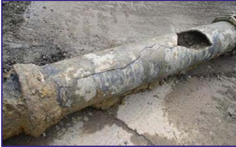
Şekil 5.6. Su koçu darbesi nedeniyle kırılan bir boru
