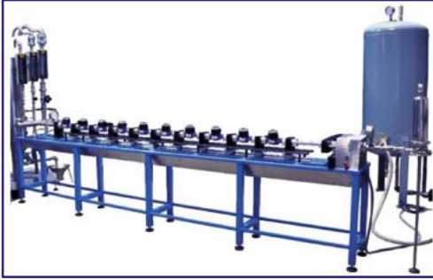
Şekil 3.6. Abone sayaçlarının hassasiyeti, hassas bir ana debimetreye bağlı bir sistem üzerinde test edilebilir.
