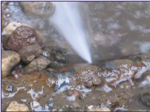
Şekil 1.1. Fiziki su kayıplarına ait bir görüntü (eski bir boruda oluşan sızıntı)
