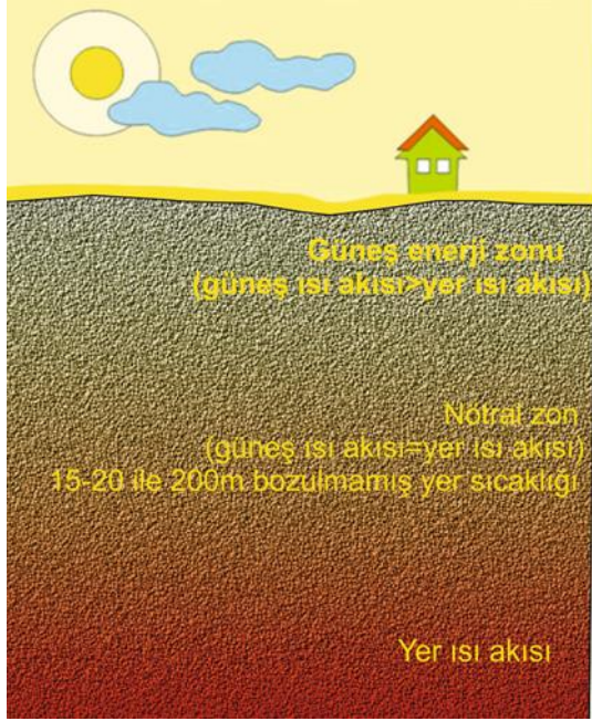
Şekil 1 - Yer içindeki derinliklere bağlı ısı akısı bölgelerinin şematik gösterimi (SenGesUmV, 2010 dan değiştirilerek)
