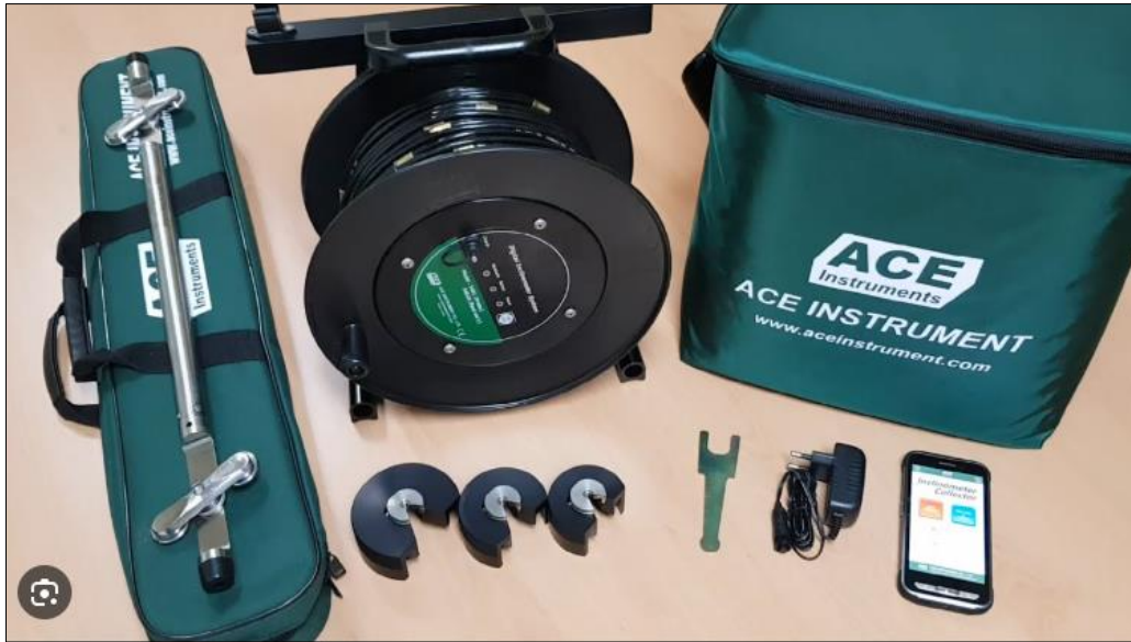
Şekil 1. İnklinometre cihazı bileşenleri (ASTM D6230, 2013)
