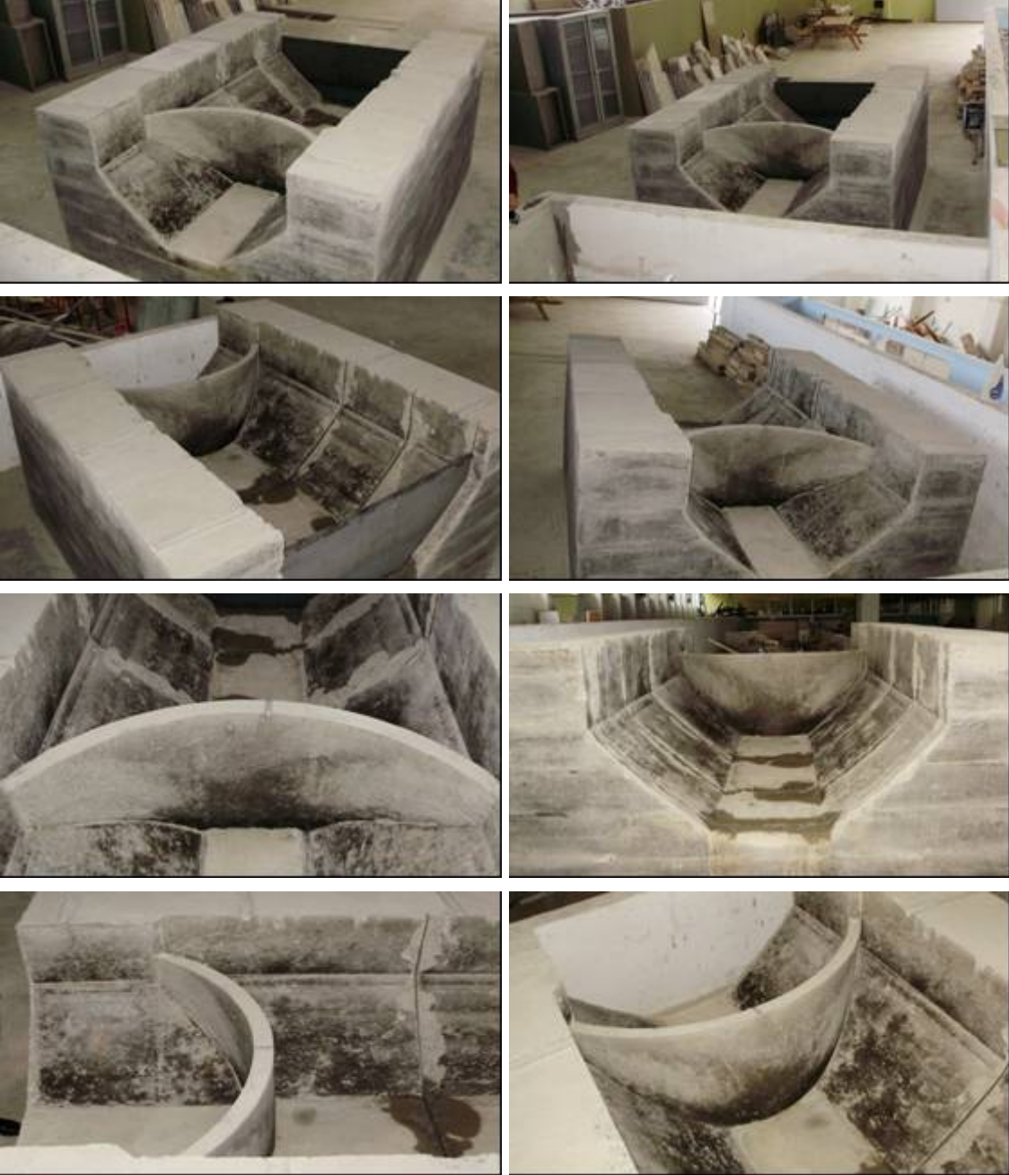
Şekil 13 - Ahşap kalıp söküldükten sonraki görüşler
