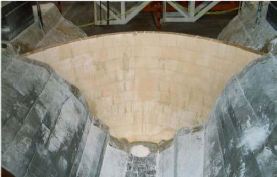
Şekil 4 - Kemer barajın deneysel modeli [Wang ve Li, 2006]
