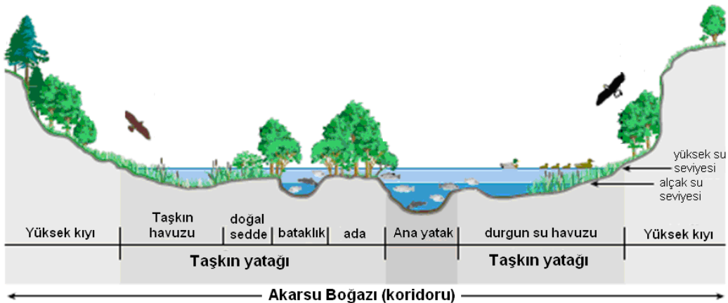
Şekil 1 - Bir akarsu boğazının enkesit görünümü
