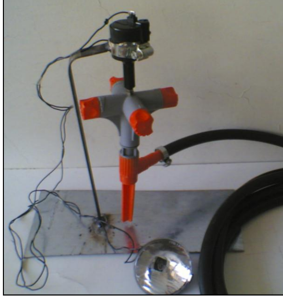
Şekil 2. Başlık ve dinamo test düzeneği (dinamo, ampul-kablo sistemi, dört kollu başlık, hortum)
