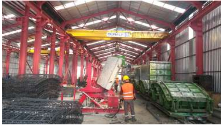
Resim 6 - Segment fabrikası, segment donatısı ve kalıbı
