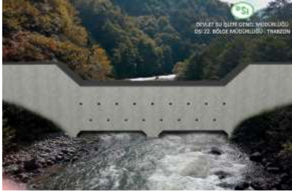
Görsel-1 - Dip açıklıklı süzücü bent tipi ve yurt dışında uygulanmış örneği
