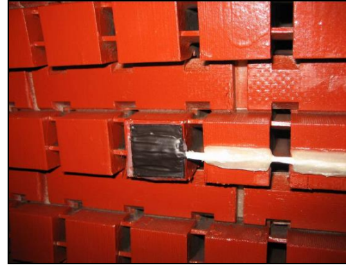
Şekil 19- Stator Çekirdek Dişine Monte Edilmiş Akı Probu(siyah) ve Bağlantı Kablosu(beyaz) [17]
