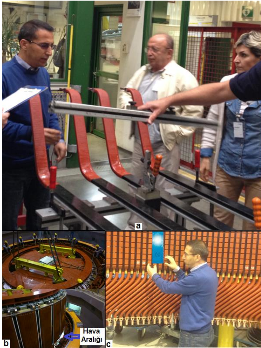
Şekil 4 - a) Stator Sargı Çubukları, b) Iisu HES Rotor İndirme İşlemi ve Jeneratör Hava Aralığı Görünümü, c) Statora Yerleştirilen Hava Aralığı Sensörü
