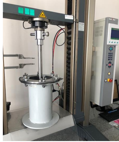
Resim-6 Statik Delme (Zımbalama) (CBR) Cihazı
