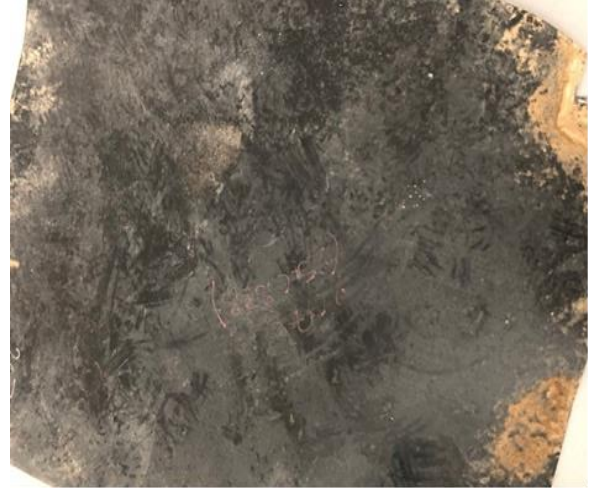
Resim-2 Doğal Ortamda Bırakılan HDPE Geomembran
