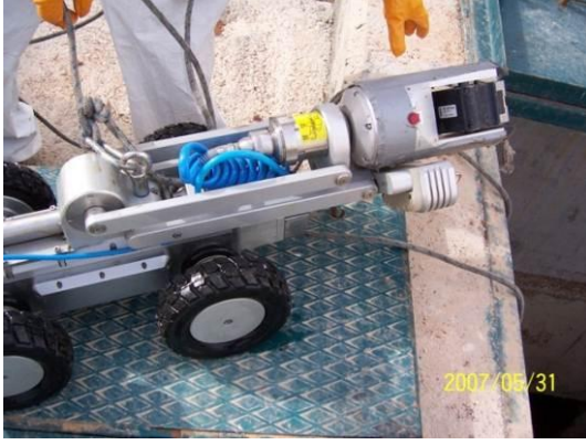
Şekil 21 - Klorlama öncesi ve sonrası boru içlerini görüntüleyen robot kamera sistemi
