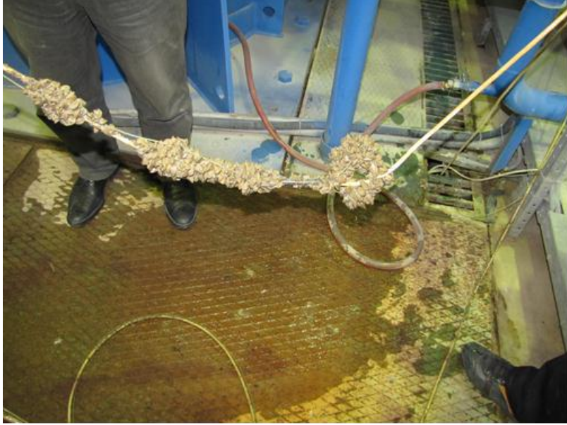
Şekil 49 - Pompa istasyonu içinde tespit edilen zebra midye görüntüleri
