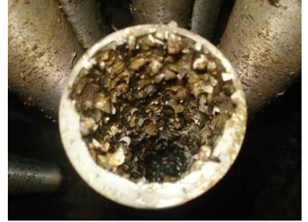
Şekil 7 - Su alma yapılarında ızgaralarda zebra midye sorunu
