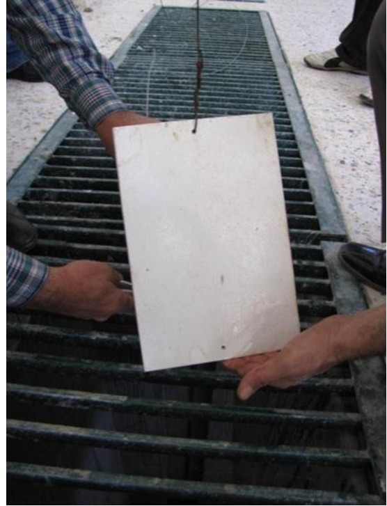
Şekil 39 - Deneme plakalarının su içine sarkıtılması
