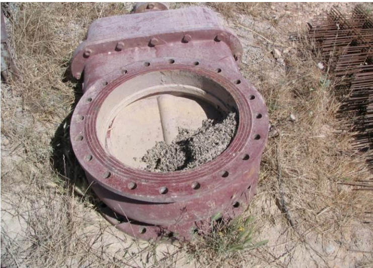
Şekil 9 - Hidrantlarda zebra midye sorunu
