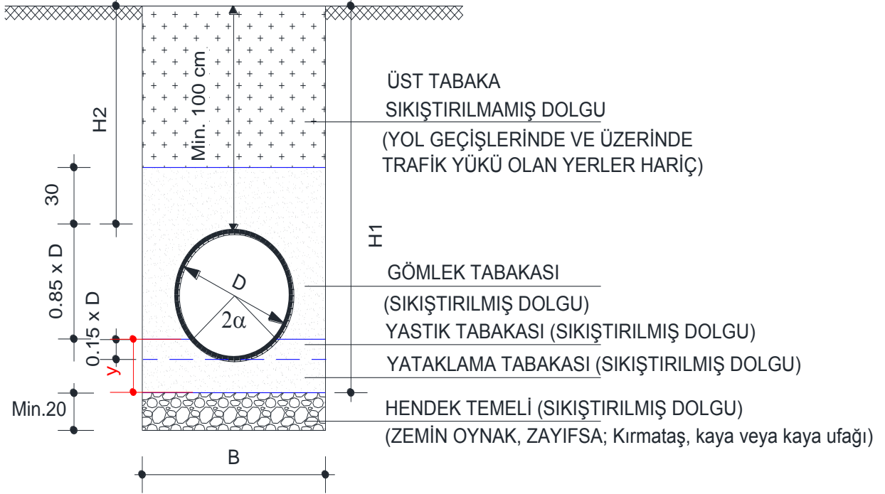
Resim 1 – CTP boru tip hendek kesiti
